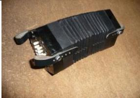
Guide Chant kasriel : Le guide-chant est un petit harmonium utilisé en cours de chant ou de musique. C'est un instrument à vent, équipé de 37 anches libres de do à do sur trois octaves. Les anches sont en laiton.
